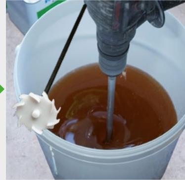
Zunächst wird die benötigte Menge der A-Komponente in einen sauberen Eimer gefüllt. Dann wird die zugehörige Menge der B-Komponente hinzugefügt. Die beiden Komponenten werden sorgfältig in einem Mischungsverhältnis von 1:1 (A : B) gemischt, bis eine homogene Farbe (streifenfrei) erreicht ist.
